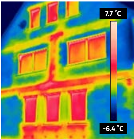
Warmtescan: warmteverlies aan de glasranden wordt verder beperkt door de Warm-Edge Spacer
